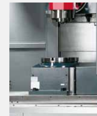
旋轉工作台 (C軸)可與機器分離安裝 (BX300A / 500A / 700A / 900A)
